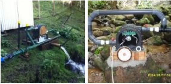
Ejemplos gráficos de conexión con 2 ó más microturbinas: Potencia total= suma individual de cada microturbina.  $P_t = P_1 + P_2 + \dots + P_n$
