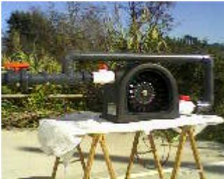
El [kit hidráulico para la turbina PLT](#) se entrega en PVC y PN 16bar (foto izq.)
