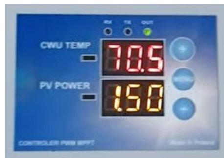
El controlador, además de las configuraciones descritas anteriormente, no requiere ninguna acción adicional ni de mantenimiento. El ajuste de los parámetros de funcionamiento es automático y depende en la capacidad y carga del panel. El regulador debe estar absolutamente cargado (siempre en carga).
