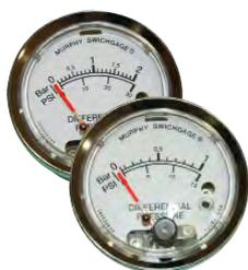
Manómetro diferencial de presión Murphy A20DPK y A25DPK con una lectura de presión diferencial de 0 a 10 m ó 0 a 20 m. La presión diferencial se ajusta entre estos dos valores. Cuando la presión diferencial alcanza el valor predeterminado (que se regula con extrema facilidad), se cierra el circuito que permite el paso de una señal eléctrica (máx. 30 VCA o VCC). Dial de 50mm Ø (A20) o 63 mm Ø (A25). Conexión con adaptador rosca hembra 1/8" BSP.
