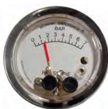
Manómetro presostato Murphy para la puesta en marcha y parada de bombas según la presión de la red. Cuando la presión alcanza el valor máximo o mínimo predeterminado (que se regula con extrema facilidad), se cierra un circuito que permite el paso de una señal eléctrica (máximo 30 VCA o VCC) para parar o poner en marcha una bomba. Dial de 63 mm Ø. Conexión con adaptador rosca hembra 1/8" BSP.
