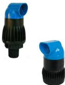
**DAV-LP-K.** Purga de aire automática PN10. Mientras la tubería se está llenando, a baja presión, la ventosa expulsa grandes cantidades de aire (función cinética "aire"). Cuando la tubería se está vaciando o la presión interna es inferior a la atmosférica durante un transitorio, la ventosa permite el reingreso de grandes cantidades de aire (función cinética "vacío").
