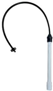
Espiga de 7 mm para conectar el tubo flexible a la tubería secundaria. Tubo flexible de 7 x 9 mm Ø y 60 cm de largo. Espiga de 7 mm para conectar el tubo flexible al tubo de PVC (peso hidráulico). Tubo PVC 1/2" Ø (peso hidráulico) y 30 cm de largo. Manguito 1/2" PVC a 1/2" rosca hembra NPT.
