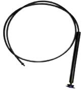
Espiga de 6 mm para conectar el tubo flexible a la tubería secundaria. Tubo flexible de 6 x 7,5 mm Ø y 60 cm de largo. Peso deslizable de PE - 28 gr.
