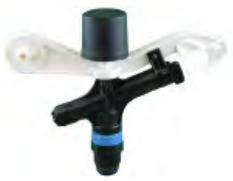
**SERIE 50-1.** Seis boquillas disponibles con caudales entre 1.475 - 3.975 l/h a presiones entre 2,10 - 4,50 Kg/cm<sup>2</sup>. Radio de alcance de 11,7 a 19,2 m. Modelo normalizado con boquilla 15 (marrón oscuro). Conexión con rosca macho 3/4" NPT. Ángulo de 12° y 23°.
