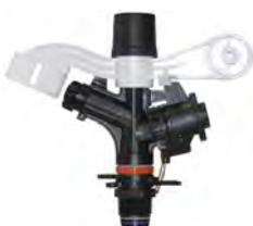
Tres boquillas disponibles con caudales entre 550 - 1.175 l/h a presiones entre 2,10 - 3,80 Kg/cm<sup>2</sup>. Radio de alcance de 5,7 a 7,1 m. Modelo normalizado con boquilla 8 (lavanda).
