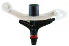
**SERIE 70-1.** Seis boquillas disponibles con caudales entre 1.965 - 7.180 l/h a presiones entre 2,75 - 4,85 Kg/cm<sup>2</sup>. Radio de alcance de 16,9 a 20,9 m. Modelo normalizado con boquilla 20 (turquesa oscuro). Conexión rosca macho 1" BSP. Ángulo de 23°.
