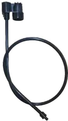
Espiga de 7 mm para conectar a la tubería secundaria y conexión presión soporte 8, 22 y 26 mm. Microtubo de 7 x 9 mm Ø y 90 cm de largo. Conexión tubo flexible y rosca hembra 1/2" NPT
