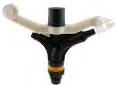
**SERIE 80-1.** Nueve boquillas disponibles con caudales entre 5.725 - 20.145 l/h a presiones entre 2,75 - 5,17 Kg/cm<sup>2</sup>. Radio de alcance de 20,4 a 29,8 m. Modelo normalizado con boquilla 32. Conexión rosca macho 1 1/4" BSP. Ángulo de 23°.
