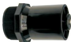
Permite el vaciado automático de las tuberías secundarias con lo que descarga al exterior cualquier acumulación de suciedad o precipitados. Imprescindible para las instalaciones de riego por goteo enterrado. Evacua un caudal de hasta 115 l/min hasta tanto no alcance una presión de 5 m (0,5 Kg/cm<sup>2</sup>) en cuyo momento se cierra.
