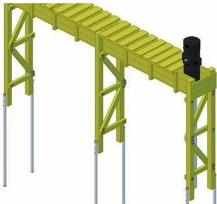
Canal con soportes de madera tratada (pino por ejemplo). Puede tener una vida útil de 50 o más años, si se va tratando la madera.
