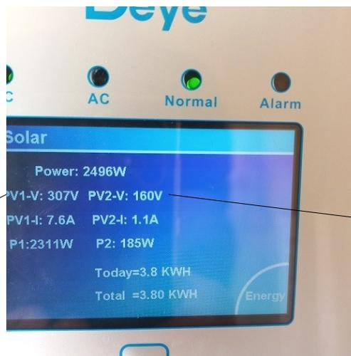
La entrada 2 (PV2), se utiliza para la turbina PLT. En aquel momento proporcionaba 160V y 185W de potencia (= equivalente a 4,4kWh/día de energía)
