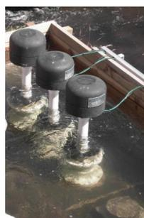
En turbinas en paralelo, asegúrese de que la distancia entre turbinas sea al menos de 350mm.
