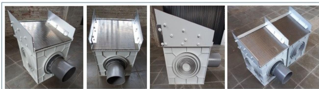
(foto10: Ejemplo de una caja de acometida para una turbina TRG con tubo de salida frontal -poco recomendado-. La malla es coanda y permite unos 15-18 L/s de captación por caja).
